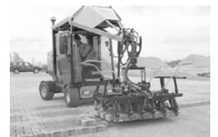
Vakuum-Handverlegegerät, Verlegemaschine [Quelle: Mentlein 2014]
