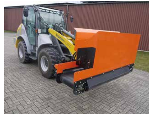
Material-Verteil-Schaufel „FinLiner“ – Erfindung von Florian von Fintel, die 2015 auf den Markt kam
