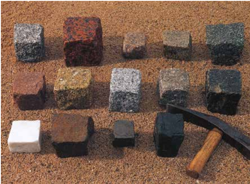
Auswahl an Pflastersteinen von Granit (die ersten vier Steine der 1. Reihe und alle Steine der 2. Reihe) über Diabas (1. Reihe rechts) bis hin zu Marmor, Porphyr, Grauwacke und Basalt (untere Reihe) [Quelle: Kolb 2010]
